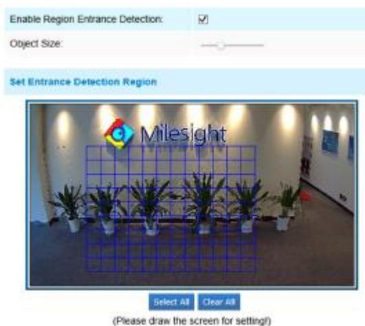
Aktivieren Sie die Regionseingangserkennung und zeichnen Sie eine Region, indem Sie mit der Maus klicken. Jedes Objekt, das in den Bereich eintritt, wird einen Alarm auslösen. Mit der "Objektgröße" kann festgelegt werden, ob ein Objekt groß genug ist, um den Alarm auszulösen, wenn er in den ausgewählten Bereich eintritt.
